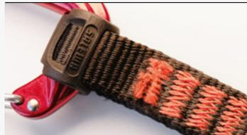
**6** Tragende Nähte bestehen bei textilen Ausrüstungsgegenständen immer aus Fäden in Kontrastfarbe. Verletzungen dieser Nähte sind ein Aussonderungsgrund.
