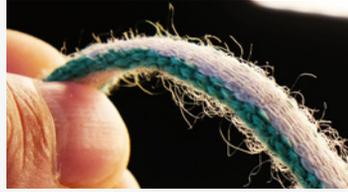
**5** Auch der langsame Verschleiß durch normalen Gebrauch schwächt Bandmaterial. Vor allem dünne Polyethylen-(Dyneema-)Schlingen sind so nahe am Normwert ausgelegt, dass sie schon bei wenig Aufpehlung schnell kritisch werden. Empfehlung: Dünne Dyneema-Schlingen schon nach 3-5 Jahren Gebrauch aussortieren.
