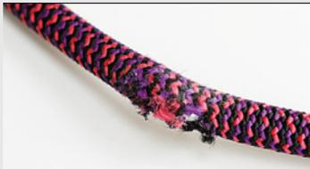
**2** Bei Kernmantelkonstruktionen (Seile und Reepschnüre) wird der tragende Teil (der Kern) vom Mantel geschützt. Sie sollten spätestens dann ausgesondert werden, wenn der Kern sichtbar wird, etwa nach einem Stein Schlagtreffer. Ein Seil kann man eventuell abschneiden, wenn der verbleibende Rest noch ausreichend lang für eine sinnvolle Verwendung ist.
