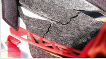
**1** Schon ein kleiner Riss im Styropor eines Helms kann die Kraftaufnahme und -verteilung negativ beeinflussen, der Schutz gegen Stein Schlag oder Anprall ist dann nicht mehr voll gewährleistet. Kleine, leichte Dellen, wie sie bei Inmoldinghelmen sehr schnell entstehen, sind in der Regel unbedenklich.
