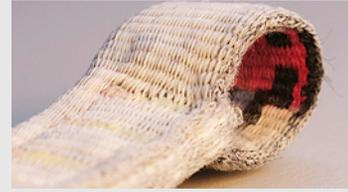
**9** Fix-Exen, Sanduhrschlingen und Abseilstände, die permanent den Witterungsbedingungen ausgesetzt sind, leiden unter der Materialschwächung durch UV-Belastung. Stark ausgebleichte Farben sind eindeutige Warnzeichen und eine Empfehlung, sie durch eigenes Material zu ersetzen. Kernmantelmaterialien sind hier besser, da der Mantel den tragenden Kern schützt.
