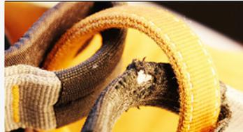
**7** Anseilgurte haben oft einen Abriebeschutz im Bereich des Anseilrings – dort, wo das Seil ständig reibt. Sobald dieser Schutz durchgeschuert ist, sollte der Gurt ausgedondert werden. Dringend abzurufen ist davon, den Abriebeschutz mit Klebeband zu verstärken oder zu „erneuern“! Die chemischen Bestandteile des Klebstoffs können das Material zusätzlich schwächen.
